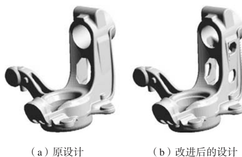
图2 汽车转向节在满足原设计(左)负载要求的同时进行轻量化设计(右)重量减轻19%
