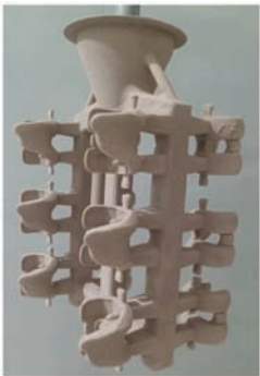
图1 蜡模组焊接方式及浇注系统
