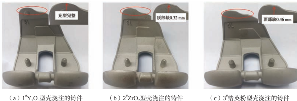
图5 采用不同型壳成形的股骨髁铸件
