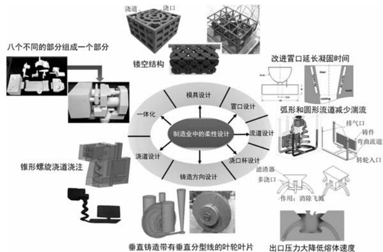
图1 3D打印铸造优势
