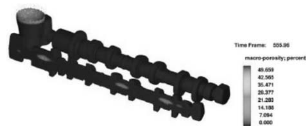
图5 凝固后缩孔位置分布
