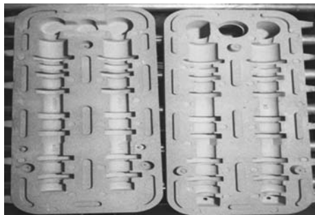
图8 固化后的壳型
