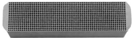
图4 铂力特在2016年珠海航展上展出的3D打印钨合金零件
