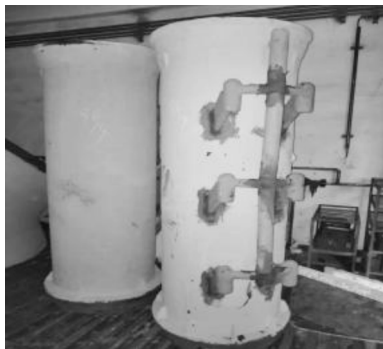
图7 整铸短模型浸涂及浇道组接
