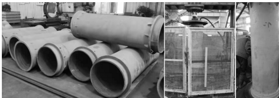
图9 整铸短顶管铸件机加工及水压检验
