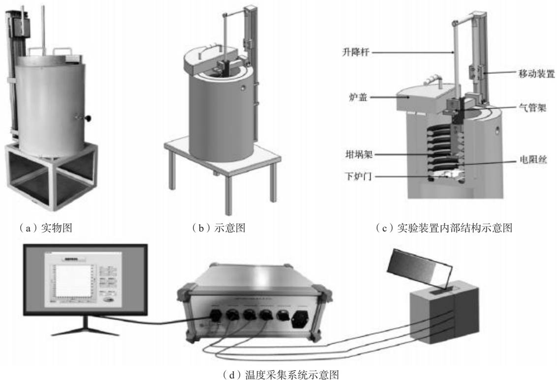
图1 阶段淬火实验装置及内部结构示意图
