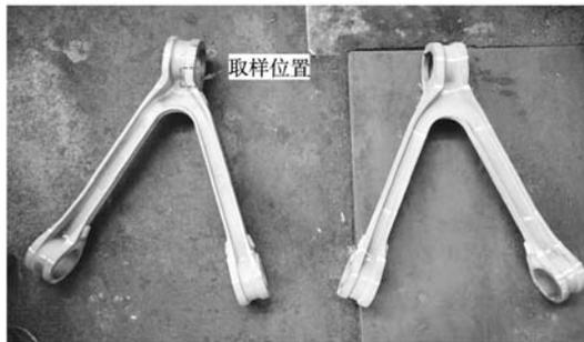
图6 V型推力杆铸件毛坯展示
