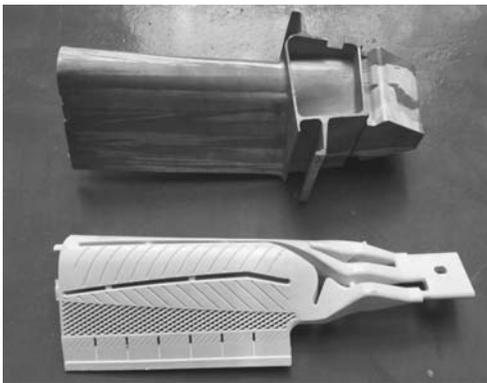
图8 氧化铝基陶瓷型芯和涡轮叶片
