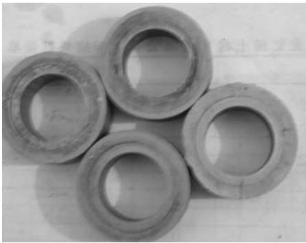
图3 用于磨损试验的试样
