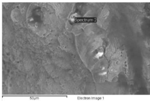
图13 轻稀土变质线处理后试样断口夹杂物分析
