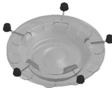
图10 铸件缩孔缩松预测
