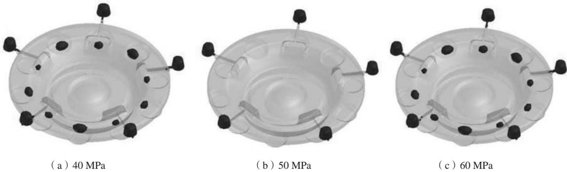
图8 不同比压下缩孔缩松模拟结果
