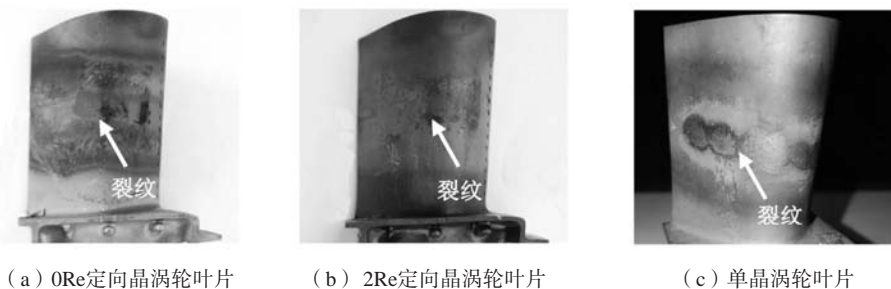
图2 涡轮叶片热冲击疲劳后宏观形貌
