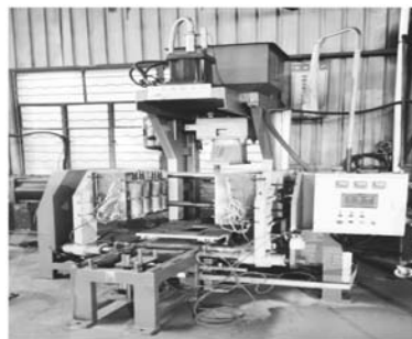
图2 三开模垂直分型全自动热芯盒射芯机
