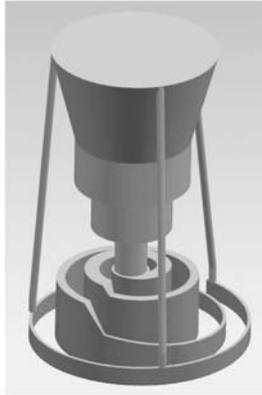
图2 单螺旋流动性测试模型及浇冒系统
