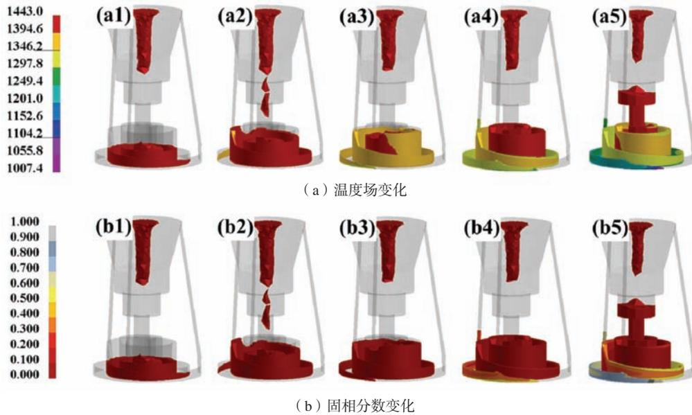
图7 流动性试样充型、凝固过程
