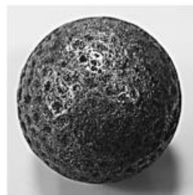
图1 工业用磨球异常磨损态形貌
