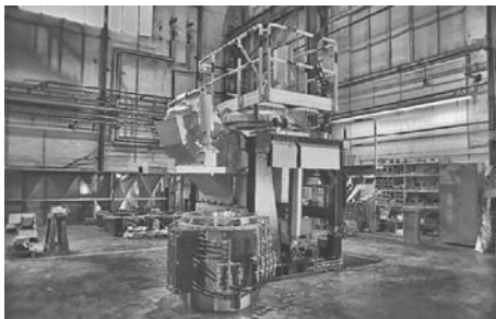
ABP感应炉公司（ABP Induction）的OCN-25感应炉系统可用于多种金属的低压铸造
