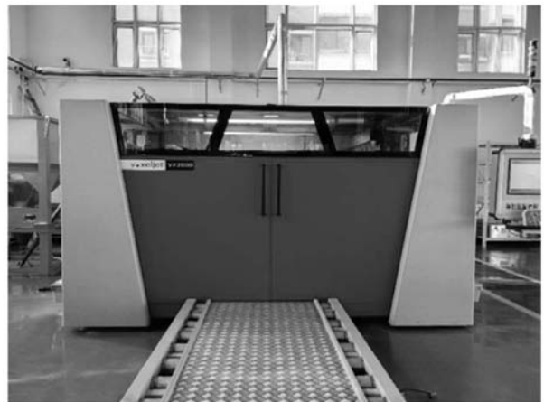
图8 砂型3D打印设备VX2000
