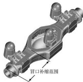
图7 载重车铸钢后桥冒口CAD效果图
