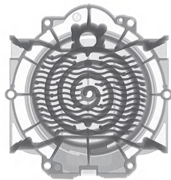
图11 涡旋盘铸件X射线无损检测结果
