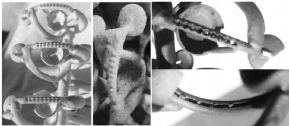
图5 常压浸浆工艺面层制备及清壳后铸件毛坯
