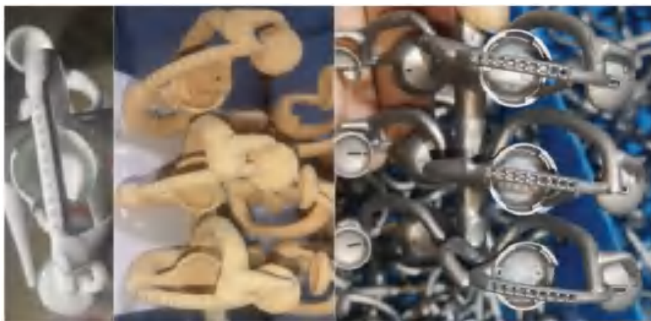
图6 负压浸浆工艺面层制备及清壳后铸件毛坯
