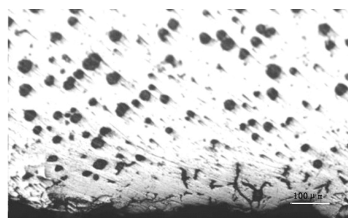
图8 使用防渗硫涂料(涂料层较厚)生产的球铁试样表面球化衰退层微观组织
