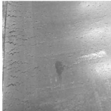
图5 Inconel 601中板 (C 0.066wt%) 热轧开裂
