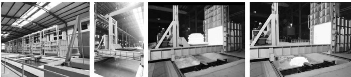
图13 适用于高锰钢件水韧处理的三维方向水平移动行架式热处理台架车的应用
