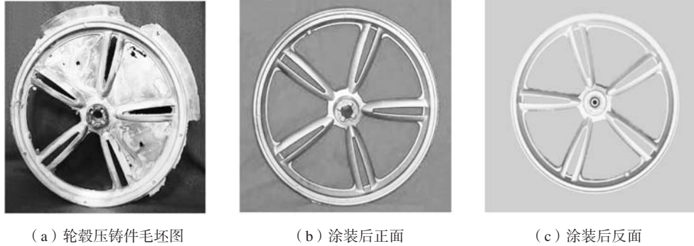
图4 压铸镁合金摩托车轮毂铸件及最后涂装图
