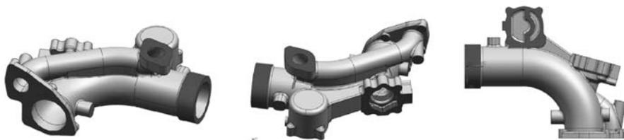
图1 出气联接管铸件结构示意图
