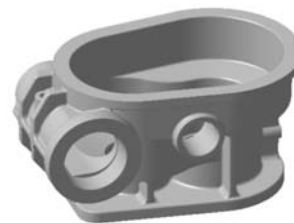
图1 变速箱箱体三维模型图 Fig. 1 3D model diagram of gearbox box
