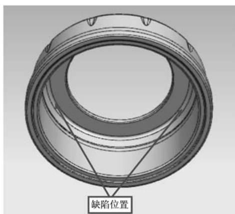
图3 重卡制动鼓结疤缺陷位置示意图
