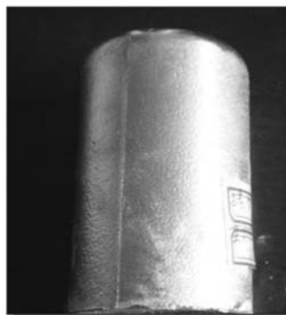
(a) 浇注的铝合金铸件
