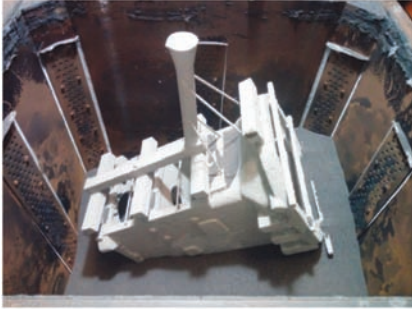
图14 黄模装箱造型
