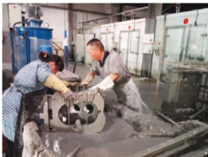
图13 施涂涂料 Fig. 13 Coating
