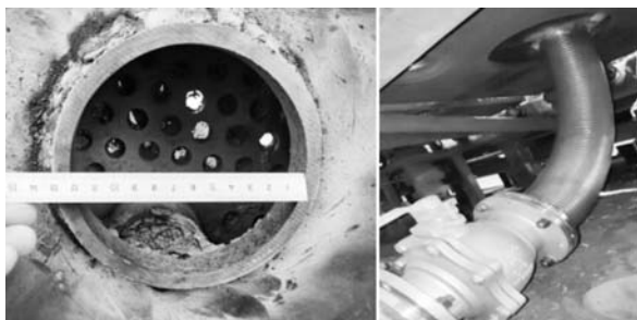
(a) 砂箱底部管径增加到 \Phi 125 mm (b) 抽真空管径更改后
