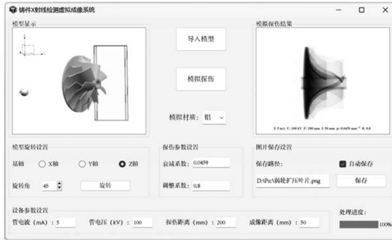
图9 虚拟成像系统主界面（探伤距离：射线源-铸件；成像距离：铸件-成像板）
