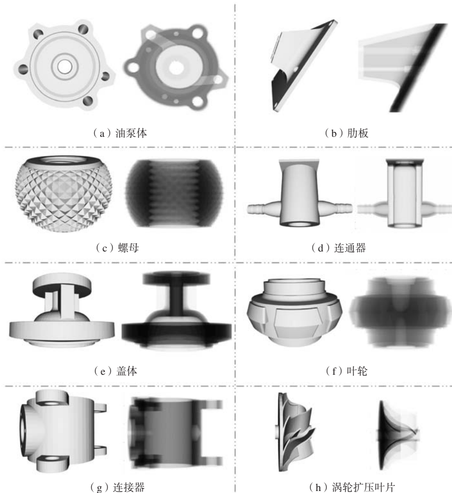
图8 虚拟X射线探伤图像
