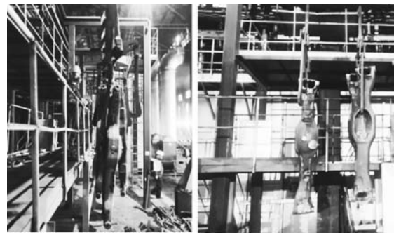
图7 热处理现场工件悬挂图片
