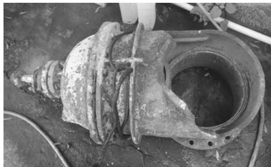
图1 控制闸阀阀体断裂宏观形貌
