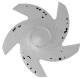
图7 初次模拟的缺陷显示图 Fig. 7 The defect display of the initial simulation
