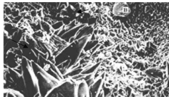
图3 Fe-25%Cr合金在1 150 ℃氧化24 h的表面形貌 Fig. 3 Surface morphology of Fe-25% Cr alloy at 1 150 ℃ for 24 h oxidation
