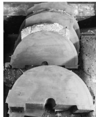
图10 “两步法”蠕化处理的玻璃模具铸件剖面
