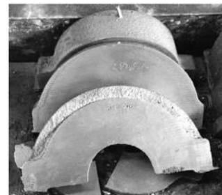
图4 玻璃模具铸件的缩松缺陷
