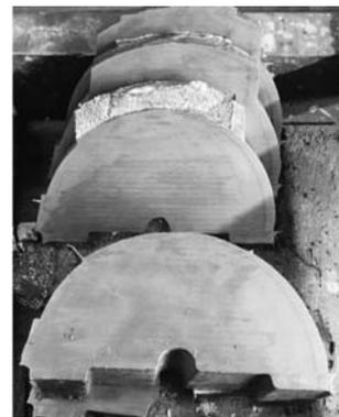
图10 “两步法”蠕化处理的玻璃模具铸件解剖面
