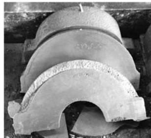
图4 玻璃模具铸件的缩松缺陷
