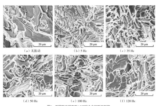
图8 不同振动频率下A357铝合金的断口形貌
