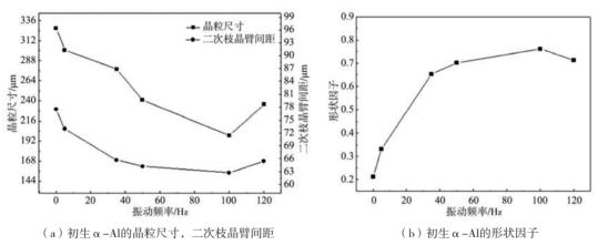
图3 不同振动频率下A357铝合金的初生 $\alpha$ -Al的晶粒尺寸,二次枝晶臂间距及形状因子
