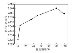
图7 不同振动频率下A357铝合金的密度 Fig. 7 Density of A357 aluminum alloy at different vibration frequencies
