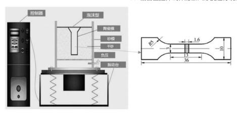
图1 机械振动装置及拉伸试样规格示意图 Fig. 1 Schematic diagram of vibration device
