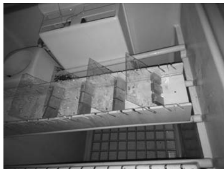
图1 试样在氯化钠盐雾箱中的放置示意图
