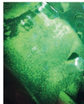
图1 铸件表面荧光异常显像
