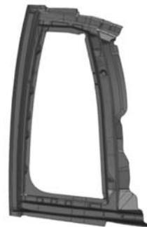
图1 汽车车门的三维几何模型示意图
