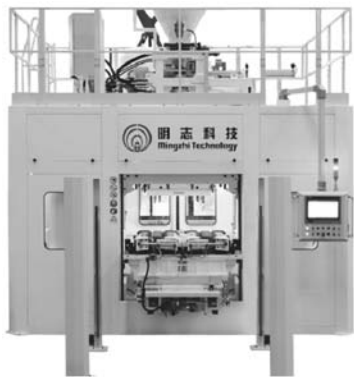
图5 MRD20V热芯盒制芯机 Fig. 5 MRD20V hot box core making machine
