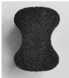
图2 泡沫砂制标准“8”字试样
