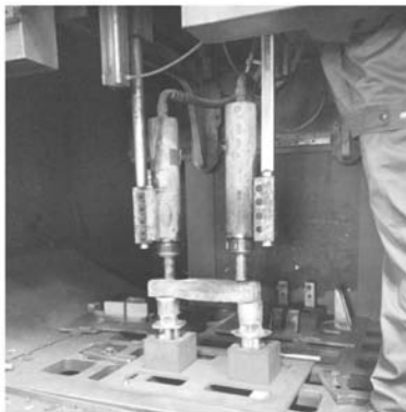
图6 震动落砂机 Fig. 6 Vibration sand blasting machine
