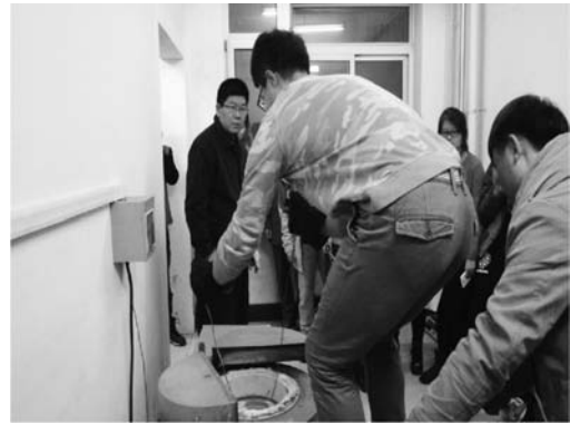
图7 学生正在进行铸件温度场实验金属熔炼操作
