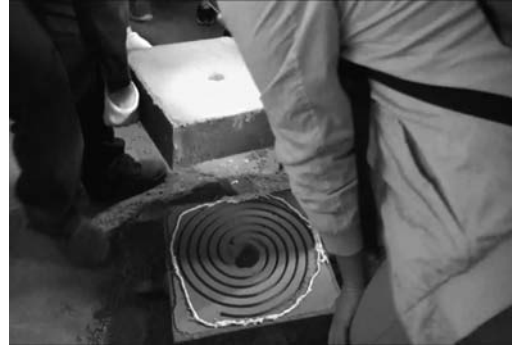
图6 学生正在进行液态金属流动性实验合型操作
