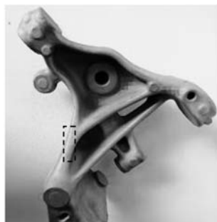
图1 汽车转向节及试验取样位置 Fig. 1 Automobile steering knuckle and test sampling position
