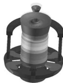
图6 重力浇注工艺凝固图 Fig. 6 Solidification time of the GDC
