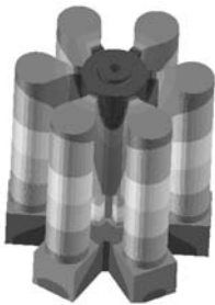
图3 低压浇注工艺凝固时间图 Fig. 3 Solidification time of the LPDC
