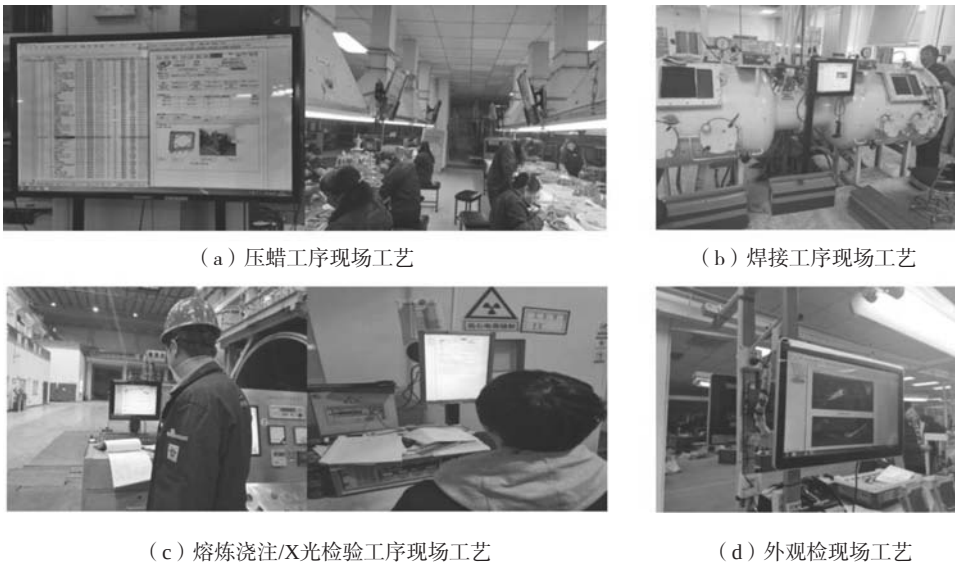
图16 熔模铸件产品的生产质量全过程数据管理 Fig. 16 Data management of production process of investment casting products
