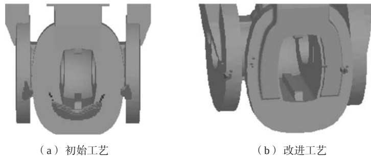
图13 定量缩孔、缩松预测结果对比图
