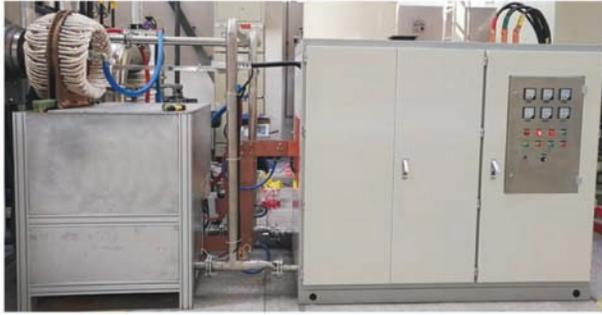
图3 真空悬浮熔炼电源系统
