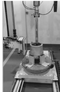
图3 微焦点数字射线自动检测
