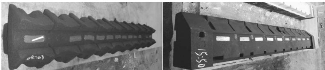
图7 V20柴油机机体的冷铁放置示意图 Fig. 7 Schematic diagram of chill placement of V20 engine block
