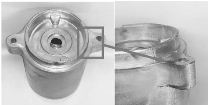
(a) 薄壁电机壳体铸件
